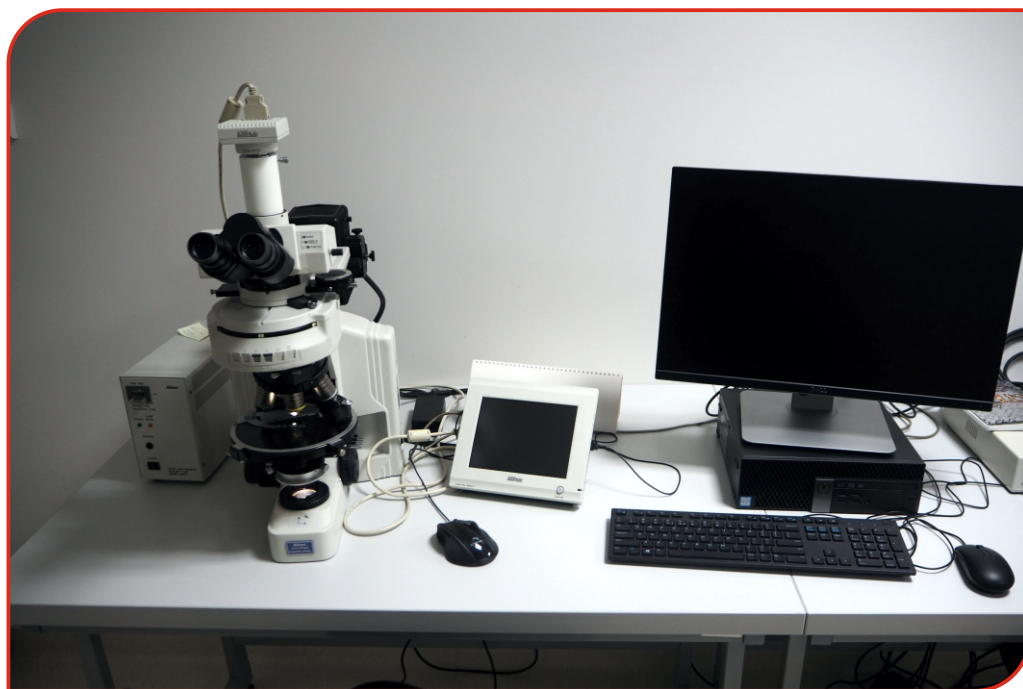
Mikroskop polaryzacyjny wyposażony w kamerę cyfrową
